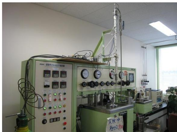
図 2-3 超臨界 CO<sub>2</sub> 精留装置
